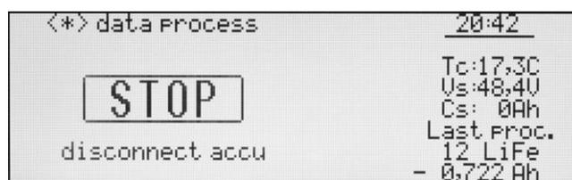
Beendigung des Prozesses ist auf der linken Seite dargestellten Display angezeigt, eine entsprechende Meldung (hier „STOP“ und das Blinken der Displaybeleuchtung) wird ausgegeben. Wenn im Setup der Beeper (akustisches Signal) aktiviert ist, wird auch akustisch signalisiert. Die akustische Signalisierung schaltet nach ca. 30 Sekunden auf ein leises Klacken um, das nach 5 Minuten abgeschaltet wird. Vor dem Start des nächsten Prozesses muss der Akku neu angeschlossen werden.
