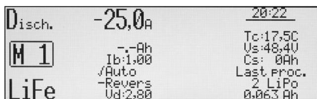
**Beschreibung des Displays.** Von oben/links: Eingestellt wurde das Entladen, in Speicherplatz 1, Akkutyp LiFe, Entladestrom ist 25 A, „-Ah“ – Limiter ist nicht aktiv, Balancer auf 1 A (Ib:1,00) eingestellt, Revers (Energierückführung) im Speicherplatz aktiviert – ist aber durch Deaktivierung im Setup-Menü inaktiv (Minuszeichen), Entladeschlussspannung (Vd:2,80)
