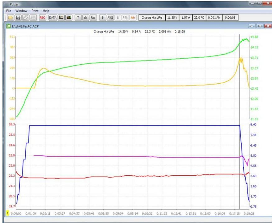
Kurven von Oben nach Unten: Grün: Spannungskurve; Gelb: Spannungsanstiegskurve (mV/min); Blau: Stromkurve; Magenta: Ri (Innenwiderstand des Akkupacks); Rot: Temperaturkurve. Unterer Teil wird angezeigt, nachdem die Taste B gedrückt ist. Im oberen Teil des Fensters werden die Spannungskurven der einzelnen Zellen angezeigt (nur bei aktivem Balancer). Auch in den Fenstern ist es möglich, die einzelnen Balancerkurven zu markieren und auszublenden (siehe Volt-Compare-Fenster).
