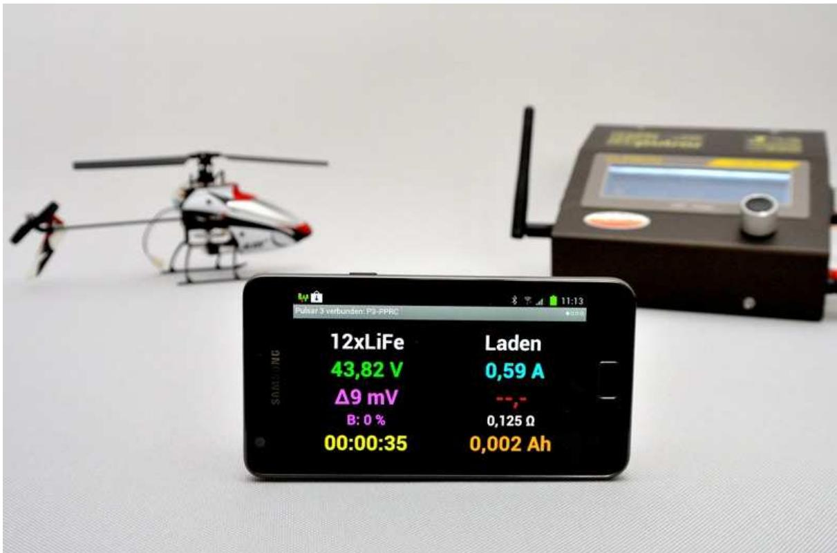
Der **Pulsar 3** kann optional mit einem BT oder BT/WLAN-Modul der Klasse 1 (bis ca. 100 m Reichweite in offenem Gelände) ausgestattet werden. In der Praxis ist die Reichweite größer (vorausgesetzt, dass das Endgerät ebenfalls mit einem hochwertigen Bluetooth-Modul der Klasse 1 ausgestattet ist) und es funktioniert auch in den Gebäuden zwischen den Etagen.
