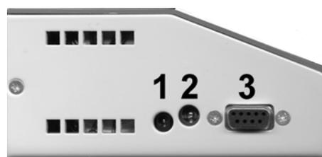
1. Temperaturfühler (mitgeliefert) Eingang bzw. Kommunikationsport für Balancer Pulsar EQUAL
