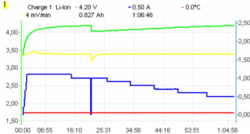
Die Ladung wird beendet, sobald die Spannung den Sollwert erreicht, der weiterhin mit niedrigerer Spannung überprüft wird. **Fast** bedeutet Impulsladung, wodurch die Ladezeit deutlich verkürzt wird. Ebenso kann im **Fast** Prozess der Ladestrom begrenzt werden. **ACHTUNG! Im Fastmodus dürfen nur bestimmte Balancer verwendet werden! Wir empfehlen den Pulsar EQUAL Equalizer der Firma ELPROG.** Die Zellen müssen immer ausgeglichen sein!
