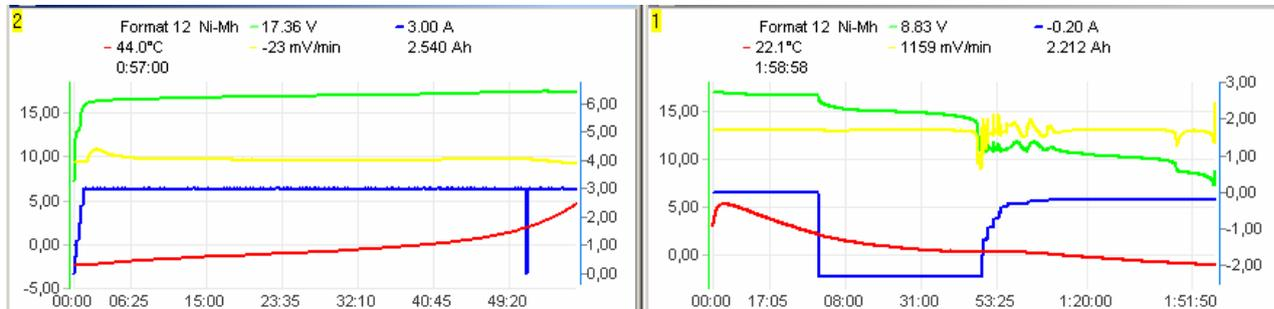
*Format* – Formieren führt die programmierte Anzahl der Lade- / Entladedurchgänge aus. Entladen wird hier in der Automatikfunktion bis zur einprogrammierten Spannung durchgeführt, die zwischen unterschiedlichen Akkutypen verschieden ist.
