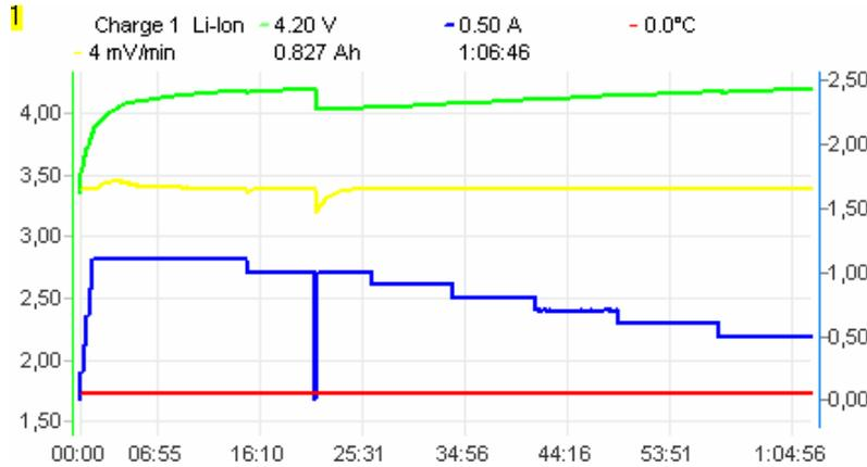
Die Ladung wird beendet, sobald die Spannung den Sollwert erreicht, der weiterhin mit niedrigerer Spannung nachgeprüft wird. **Fast** bedeutet Impulsladung, was die Ladezeit deutlich verkürzt. Ebenso kann im **Fast** Prozess der Ladestrom begrenzt werden. **ACHTUNG! Im Fastmodus dürfen nur bestimmte Balancer verwendet werden!** Die Zellen müssen ausgeglichen sein!
