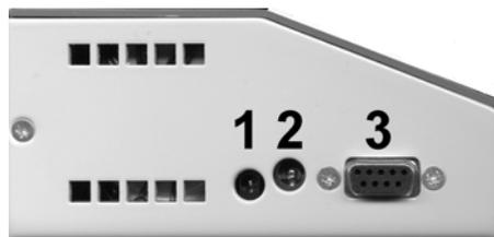
1. Temperaturfühler (beigefügt)
