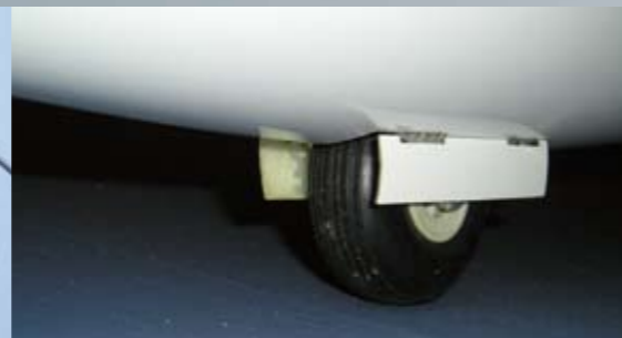
Zwei kleine Ruderscharniere pro Seite halten die Fahrwerksklappen zuverlässig an ihrem Platz
