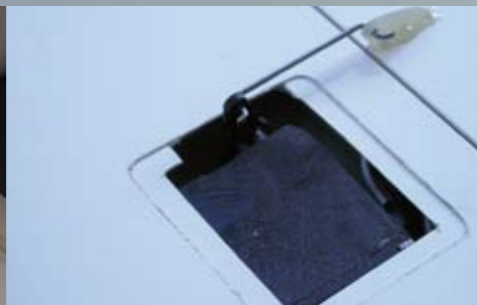
Nur „malträtiert“ passen die Querruderservos ganz in die Fläche
