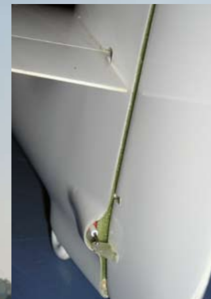
Das Seitenruder wird über einen Bowdenzug angelenkt, das Höhenruder direkt vom darunterliegenden Servo
