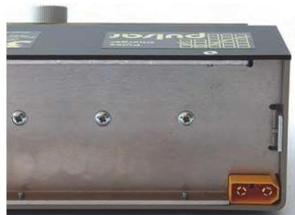
Hinten rechts wurde die XT-90-Versorgungsbuchse integriert.
