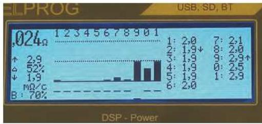
Oben: Darstellung des Innenwiderstands der seriell verschalteten LiPo-Akkus beim Laden, bestehend aus 6s (1 bis 6) und 5s (7 bis 11).
