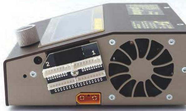
Lüftereinlass, Temperaturbuchse, verschraubter Balanceradapter sowie XT-90-Ausgangsbuchse an der rechten Gehäusewand.
