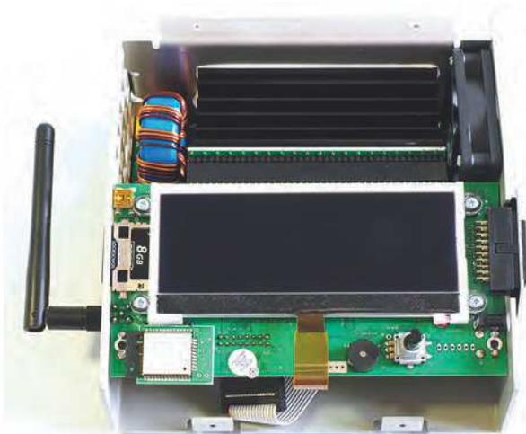
Der Blick ins Innere offenbart feinste Industrietechnik. Das Bedienpanel und der DC-DC-Wandler befinden sich auf zwei getrennten Platinen.
