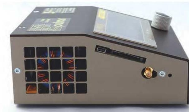
Links am P3+: SD-Kartenschacht, USB-Schnittstelle sowie SMA-Antennenanschluss.
