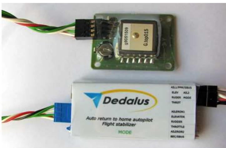
Den GPS-Empfänger (GNSS oder richtigerweise GPS+GLONASS) wird an der vorderen Seite von dem Autopiloten mittels blauem 8-Pin Stecker realisiert. Bitte auf die Steckungsnase achten, um die Verbindung auch polrichtig zu realisieren.
